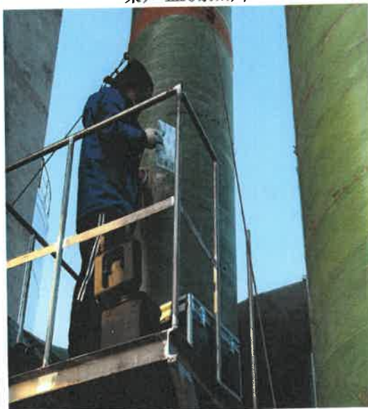
有组织废气采样照片
