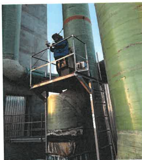
有组织废气采样照片
