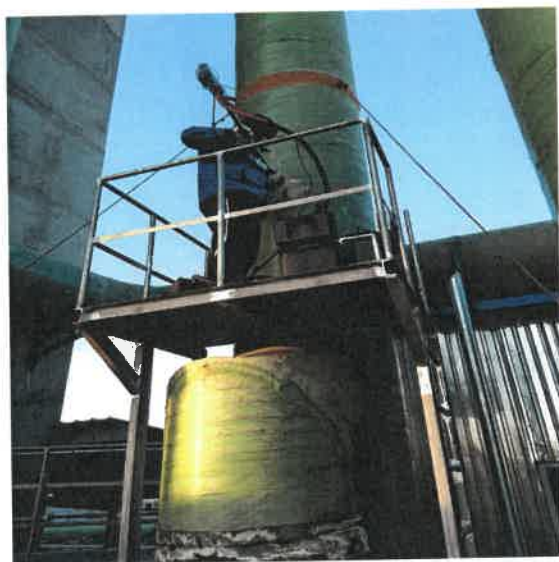
有组织废气采样照片
