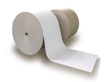
塗布白面牛卡紙為一種將塗料塗佈到已漂白 上層組成的多層紙張構成的白面牛卡紙。該塗 料使白面牛卡紙色澤更鮮明及更有光澤,令印 刷更優質,同時具備一流的輸墨質素。輕塗白 面牛卡紙的塗布層遠較傳統塗布白板紙的塗 布層為薄,故被認為更環保。
